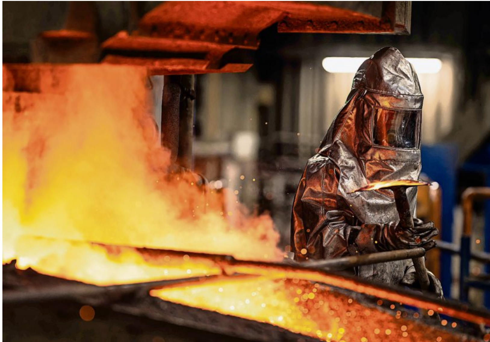
Der Badschmelzofen, das Herzstück der Nordenhamer Bleihütte, wird noch bis 2036 mit Erdgas befeuert. Ab dann kommt die Energie aus klimafreundlichem Wasserstoff.
